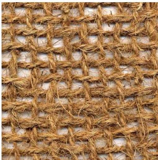
Dettaglio della biorete in cocco
